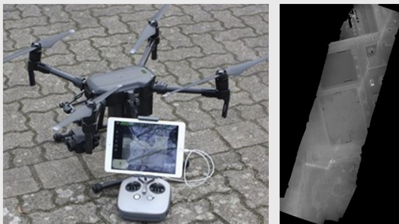
Bild 4: a) Drohne mit Kamera und Steuerung, b) ein Thermalbild
