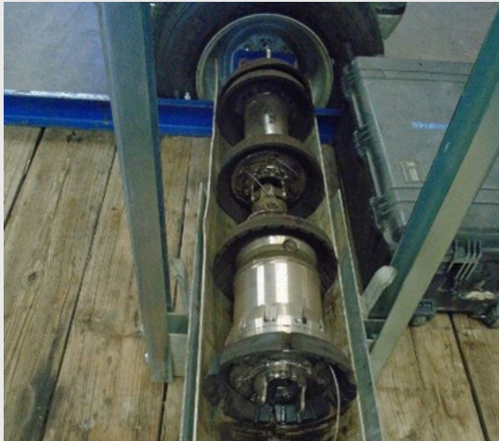
Bild 2: Das ILI-Prüfwerkzeug bei der Ankunft am Empfänger
